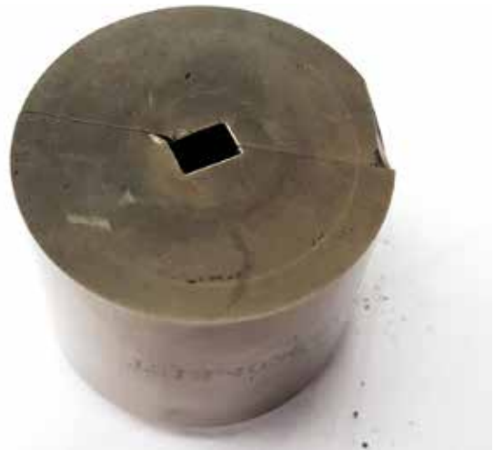
Tipičen lom orodja zaradi dinamičnega utrujanja materiala
